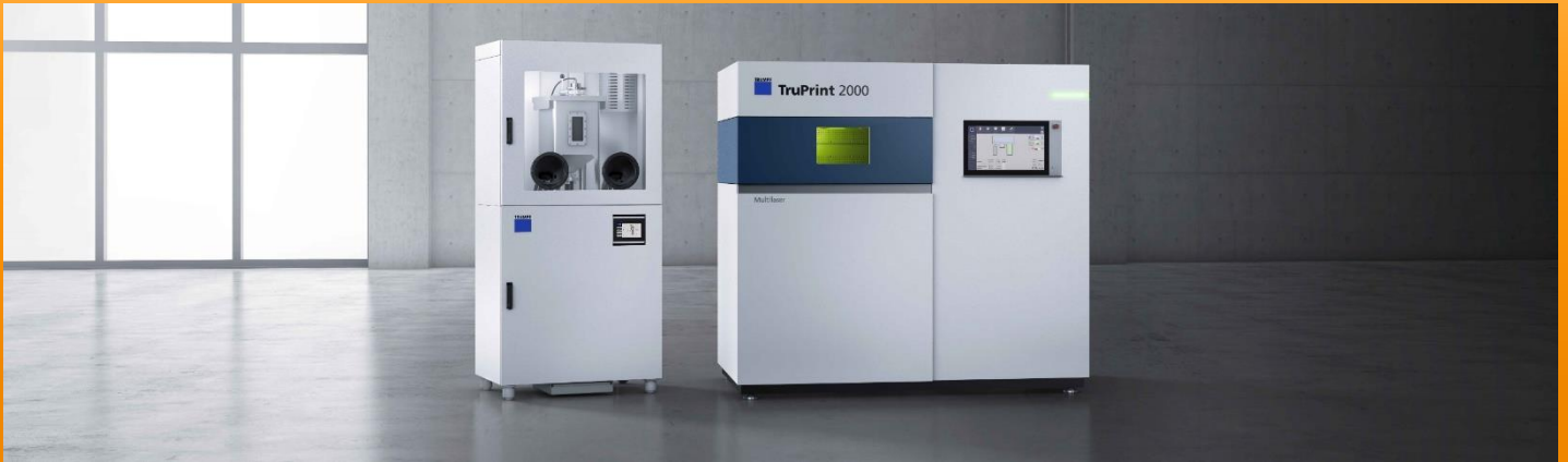
Abbildung 8: Das perfekt abgestimmte, inerte Maschinenkonzept der TruPrint 2000 mit Pulvervorbereitungsstation bietet ein hochwertiges Druckergebnis bei wirtschaftlicher Fertigung. Metallische Serienbauteile können hochproduktiv mittels Multilaser aufgebaut und innerhalb der Maschine entpackt werden. Der Fertigungsprozess der TruPrint 2000 ist auf einen geschlossenen Pulverkreislauf unter Schutzgas ausgerichtet. Dies ermöglicht einfaches, praktisches Handling sowie höchste Pulverqualität.
